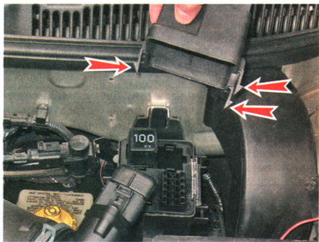
4. Извлекаем реле.
